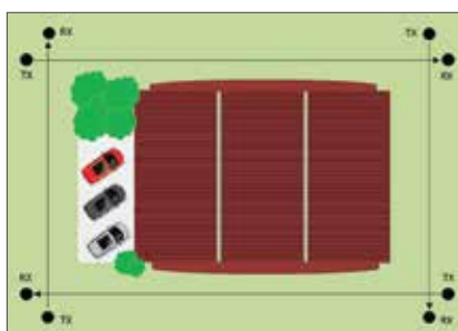
установка однонаправленных колонн
